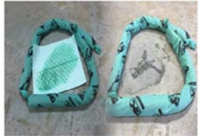
4. 用吸收材料完全覆盖溢漏物，小心清理
